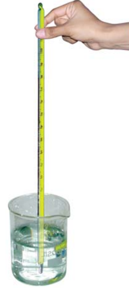
चित्र 4.5 प्रयोगशाला तापमापी द्वारा जल का ताप मापना
